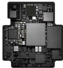
圖五、Apple Watch S1 處理器模組可望採用日月光 SiP 封裝
