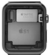
圖五、Apple Watch S1 處理器模組可望採用日月光 SiP 封裝
